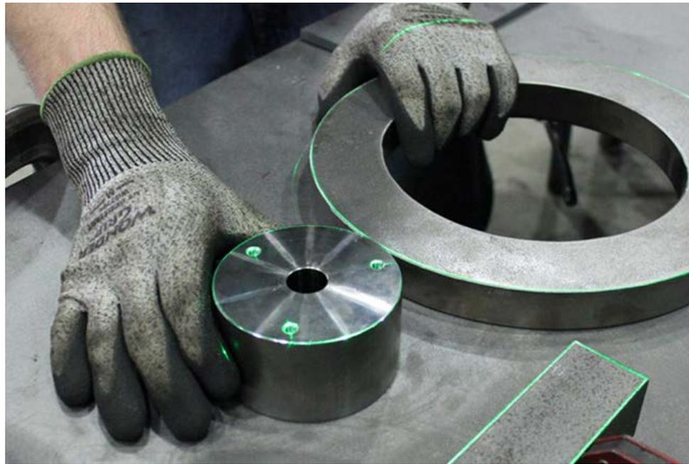
El Sistema de Posicionamiento Espacial (SPS) Virtek® Iris™ ofrece un sistema avanzado creado para guiarle en el proceso de ensamblaje y soldadura, el sistema Iris utiliza las características geométricas de las piezas para ubicar con precisión una pieza en el espacio tridimensional.
