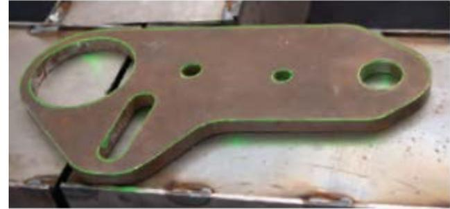
Iris elimina el error en el proceso de ensamblaje al eliminar todos los pasos de medición manual, marcado y montaje. La posición de la pieza se toma directamente de los datos CAD y se proyecta con láser en la pieza de trabajo para una colocación exacta según el diseño.
