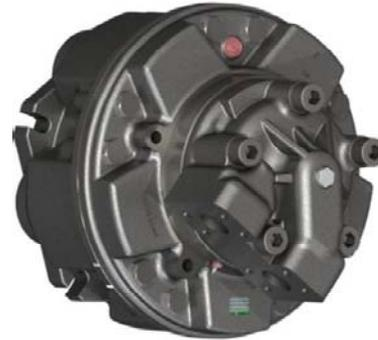
El encaje entre los motores planetarios y el rodillo se lleva a cabo mediante un eje estriado en lugar de un eje con doble chavetero como usualmente se hace. En un proceso de trabajo normal los rodillos sufren constantes cambios repentinos de dirección y esto provoca que una chaveta coja holguras enseguida. Los ejes estriados están desarrollados para este tipo de aplicación y están garantizados por el mayor constructor de cajas de cambios como es Brevini, el cual instalamos en nuestras máquinas.
