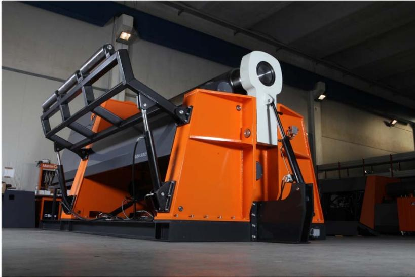
Cada parte de la máquina se encuentra sobredimensionada para asegurar la rigidez que la máquina requiere para ser precisa. Robusta estructura electro soldada combinada con robustos brazos giratorios (Swing Arms) son solo el cuerpo de nuestras máquinas. El corazón es el set de rodillos, están contruidos con acero de alta aleación y templados hasta 50-55 HRC. Se les da el abombamiento
