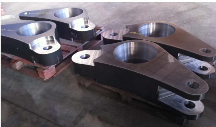
sólida pieza de acero aleado la cual se mecaniza en centros de mecanizado CNC para conseguir las tolerancias necesarias. De esta manera son completamente consistentes y reaccionan de una manera predecible y completamente controlable en la fase de diseño. Un punto clave para una máquina precisa y duradera.
