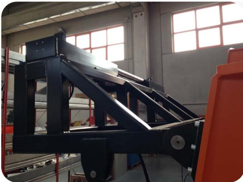
Soportes laterales de simple o doble brazo para responder a cualquier tipo de requerimiento técnico y con capacidad de carga hasta 30 tns. Se fabrican con una poderosa estructura electro-soldada y se mueven mediante cilindros hidráulicos masivos controlados directamente desde el panel de control de la máquina.
