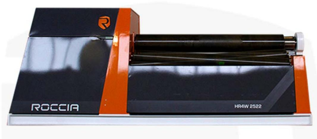
Los dos rodillos laterales pueden inclinarse hidráulicamente a ambos lados. De esta manera se tiene la posibilidad de efectuar curvados cónicos, se utiliza también para calibrar virolas no perfectamente paralelas, por ejemplo cuando un material no tiene un espesor constante en toda su longitud.
