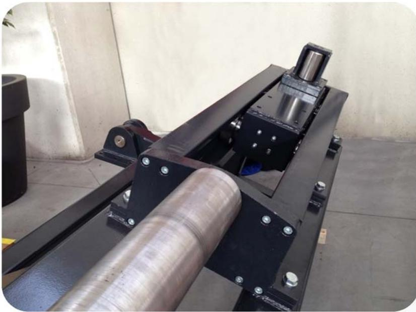
Apoyo lateral para empujar los índices para alinear la junta de la virola o para empujar la chapa a su posición mientras cilindra conos de ángulo fin. Se mueven sobre guías lineales y son empujados por fuertes pistones hidráulicos controlados por el panel de control de la máquina.
