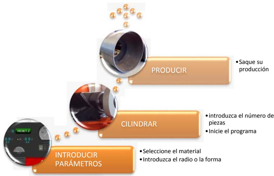
La tecnología del control CNC Newton está diseñada para calcular automáticamente la posición de los rodillos durante todo el proceso de curvado.
