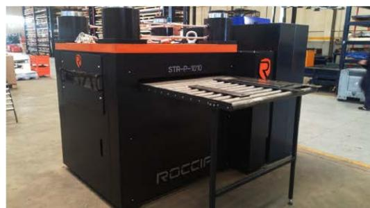
El CNC tiene una protección hidráulica, mecánica y eléctrica contra sobrecargas a fin de que la máquina pueda calcular el estrés durante el proceso de aplanado y la consecuente carga para controlarlo.
